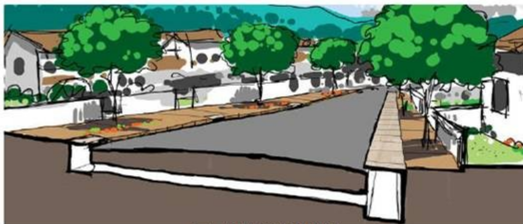
FIGURA 3.3 – DESENHO ILUSTRATIVO DE GALERIAS RETANGULARES COM TAMPAS REMOVÍVEIS.
