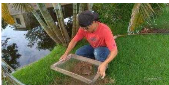
Figura 13: Desagregação, peneiramento, triagem e exame do sedimento retirado da sondagem (PT007 UTM: 22J 746568/7142851).
